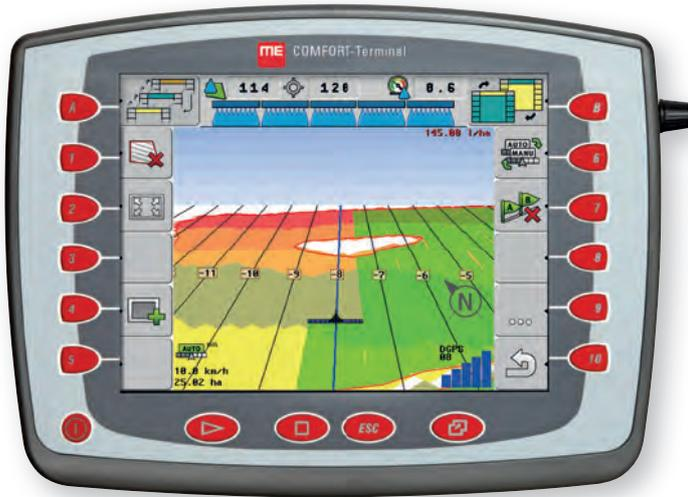
Das COMFORT-Terminal ist ein ISOBUS-Terminal und erfüllt die höchsten Ansprüche des Precision Farmings. Auf dem 10,4" großen Display lassen sich alle Details auf einen Blick erkennen. Es ist standardmäßig mit den Apps ISOBUS-UT und ISOBUS-TC (Task Controller) ausgestattet, sodass Auftragsmanagement und Applikationskartenverarbeitung im ISO-XML Format möglich sind.
