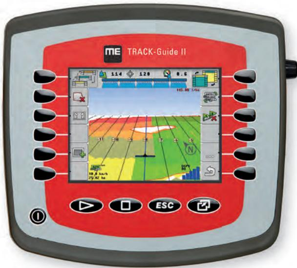
Der TRACK-Guide II ist ein leistungsstarkes Parallelfahrssystem mit vielen Erweiterungsmöglichkeiten. SECTION-Control und ISOBUS sind unter anderem erhältlich. Des Weiteren können optional eine Lightbar oder auch Kameras angeschlossen werden. Der TRACK-Guide Desktop ermöglicht die Auswertung und Speicherung der Daten.
