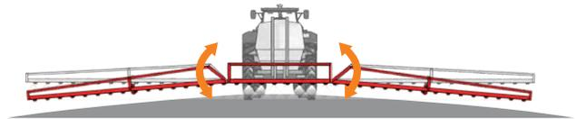
Sowohl auf den Gestängearmen als auch auf dem Mittelteil wird jeweils ein Ultraschallsensor montiert. Die Position beziehungsweise der Winkel der Gestängeteile wird durch Potentiometer oder anhand von integrierten Messsystemen in den Hydraulikzylindern ermittelt. Durch die Ansteuerung aller Gestängeteile wird eine absolut hochgenaue Abstandsregelung, selbst in stark kuppertem Gelände, erreicht.
